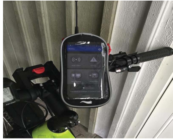
Drive-by aflæsning via mobil tlf. og antenne
